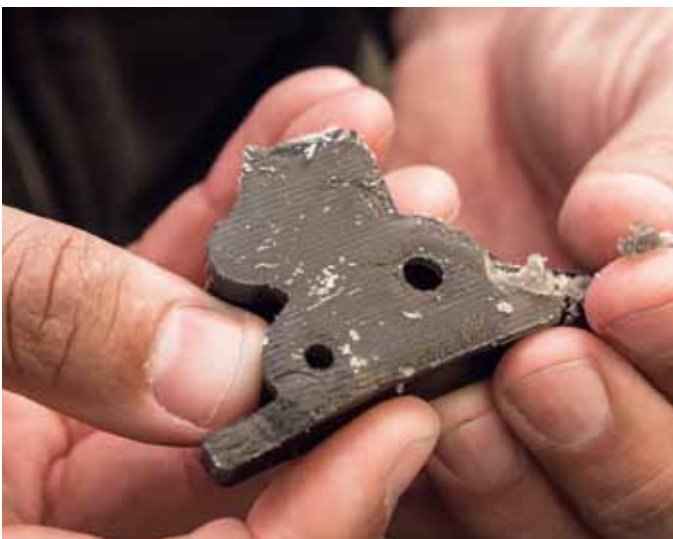
Erste Entwürfe entstehen im 3D-Drucker. Anschließend wird der Prototyp abgelöst und gereinigt
