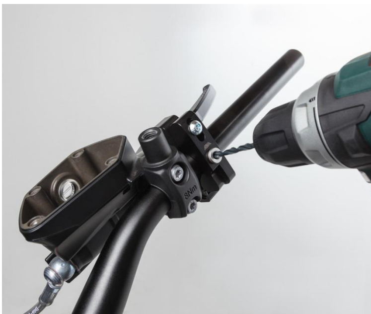
Bild 2 von 2: Kein Abrutschen, keine Schrägbohrung, kein ungewollter Versatz der Bohrung!
