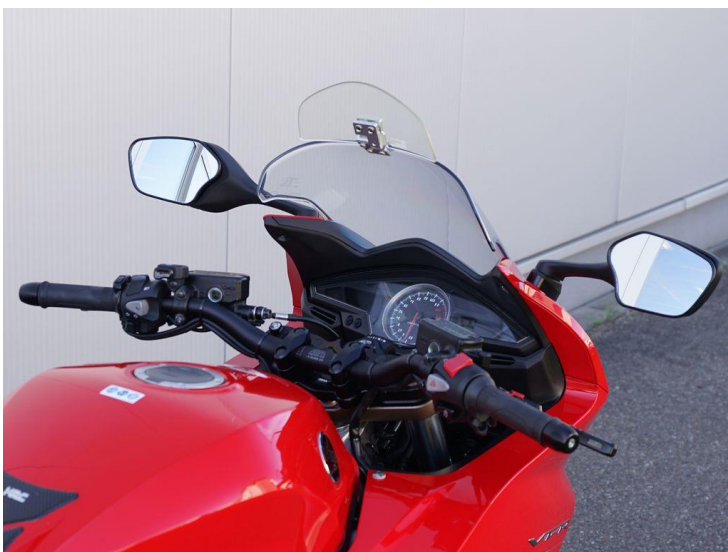
Bild 2 von 6: Lenker legt insgesamt um ca. 8 cm in der Breite zu
