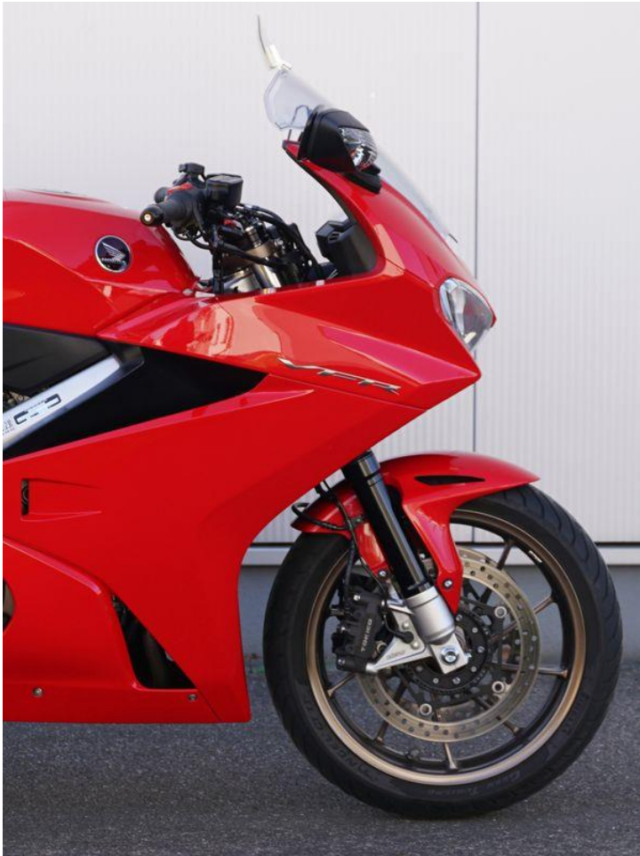
Bild 1 von 6: Lenkerposition nach Umbau um ca. 8 cm höher
