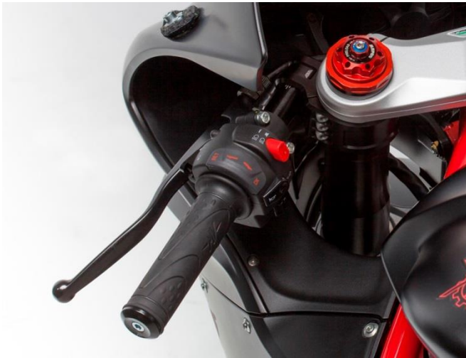
Bild 4 von 4: Verstellbarer Stummellenker raceClip für Rennbetrieb
