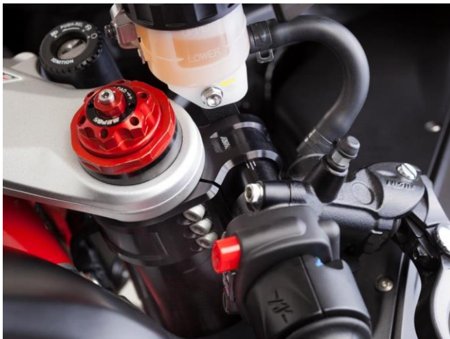
Bild 4 von 4: Verstellbarer Stummellenker raceClip für Rennbetrieb
