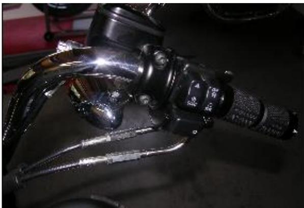
Die Schutzgummis der Gaszüge etwas nach unten ziehen und deren Kontermuttern lösen.
