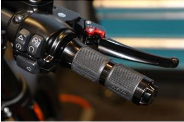
Bei zu großem axialem Spiel die beiliegende Kunststoffscheibe zwischen Griff und Armatur mit in die Führung einhängen.
