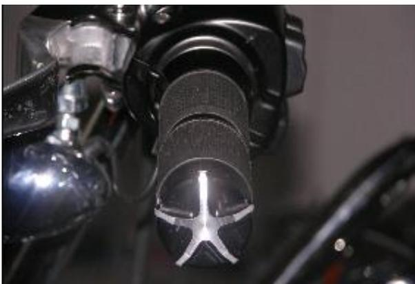
Den neuen Griff auf den Lenker schieben und mit den drei beiliegenden Madenschrauben von unten befestigen.
