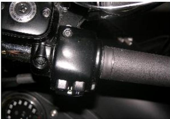
Die obere Schraube lösen und den Deckel entfernen.
