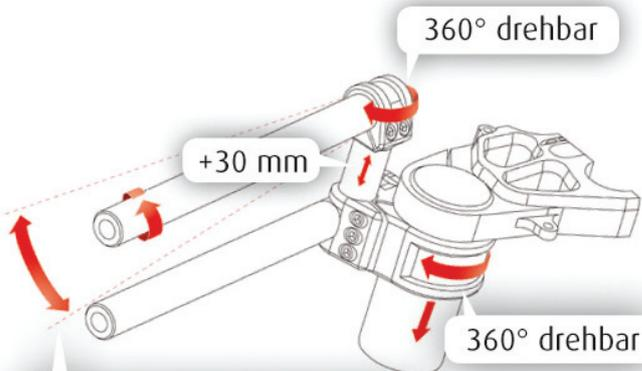
5° Biegung ermöglicht durch Drehen des Lenkrohres eine Verstellung von bis zu 40 mm
