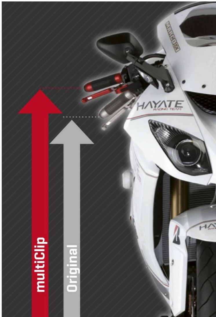
Bild 7: Erhöhte Lenkerposition mit dem ABM Stummellenker
