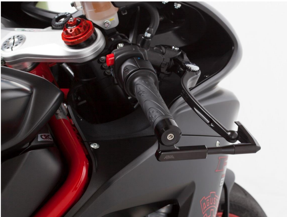
Bild 4 von 4: leverSafe schützt Hebel vor ungewollten Kontakten
