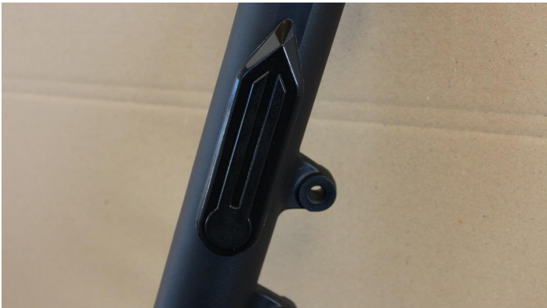
Bild 8: WUNDERKIND-Custom: Abdeckung Seitenstrahler an der Gabel
