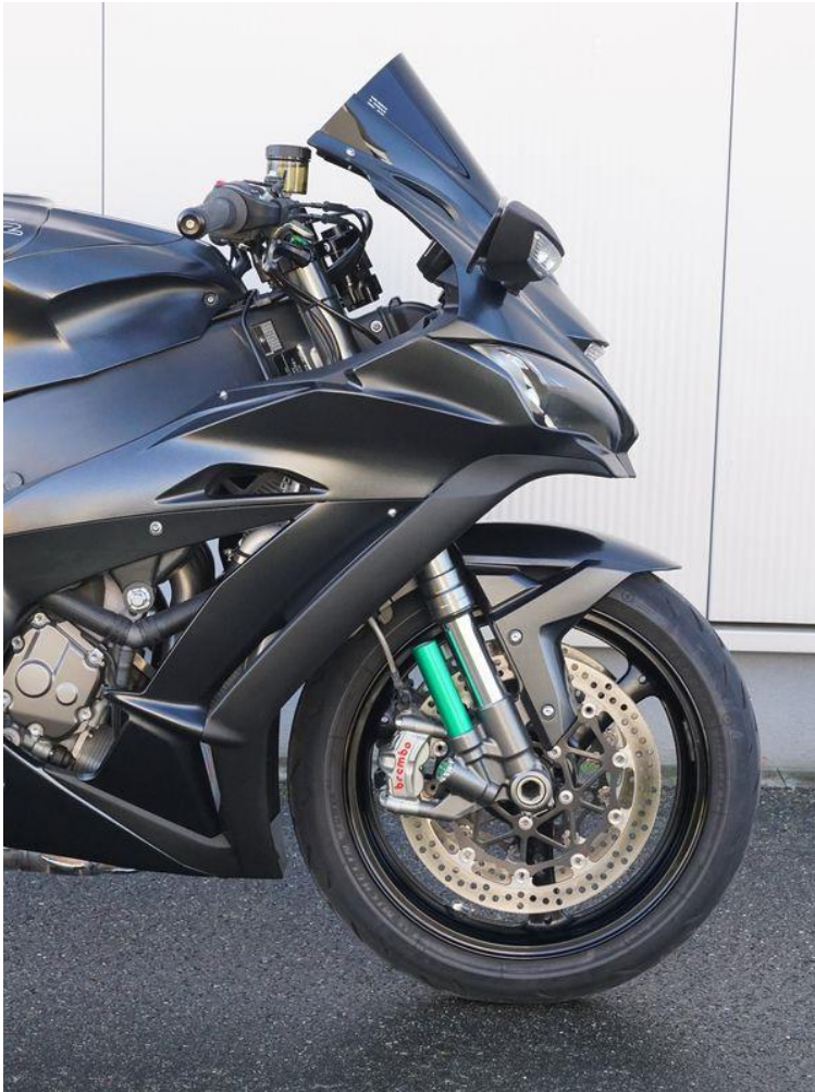
Bild 1 von 6: Lenkerposition nach Umbau um ca. 13 cm höher
