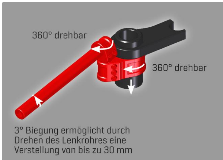
Bild 5: Beispielhafte Abbildung zu den Verstellmöglichkeiten eines Stummels, hier bei der Stummel-Version „Sport“
