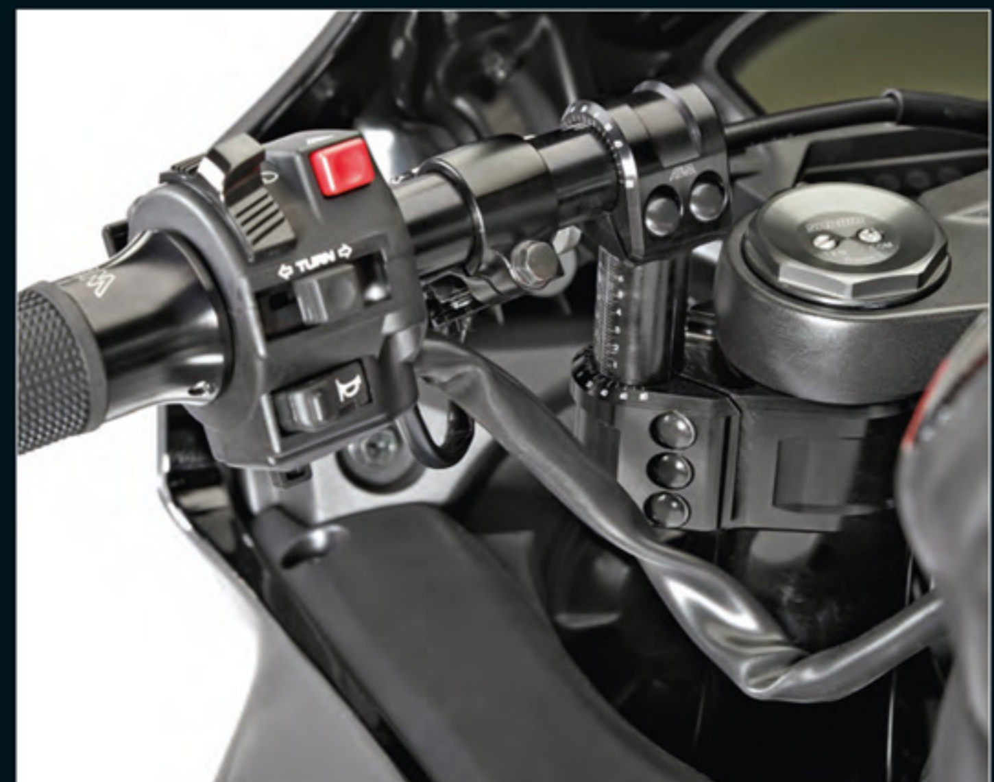
Der Multi Clip lässt sich in Höhe bis zu 70, in der Kröpfung bis zu 40 Millimeter einstellen
