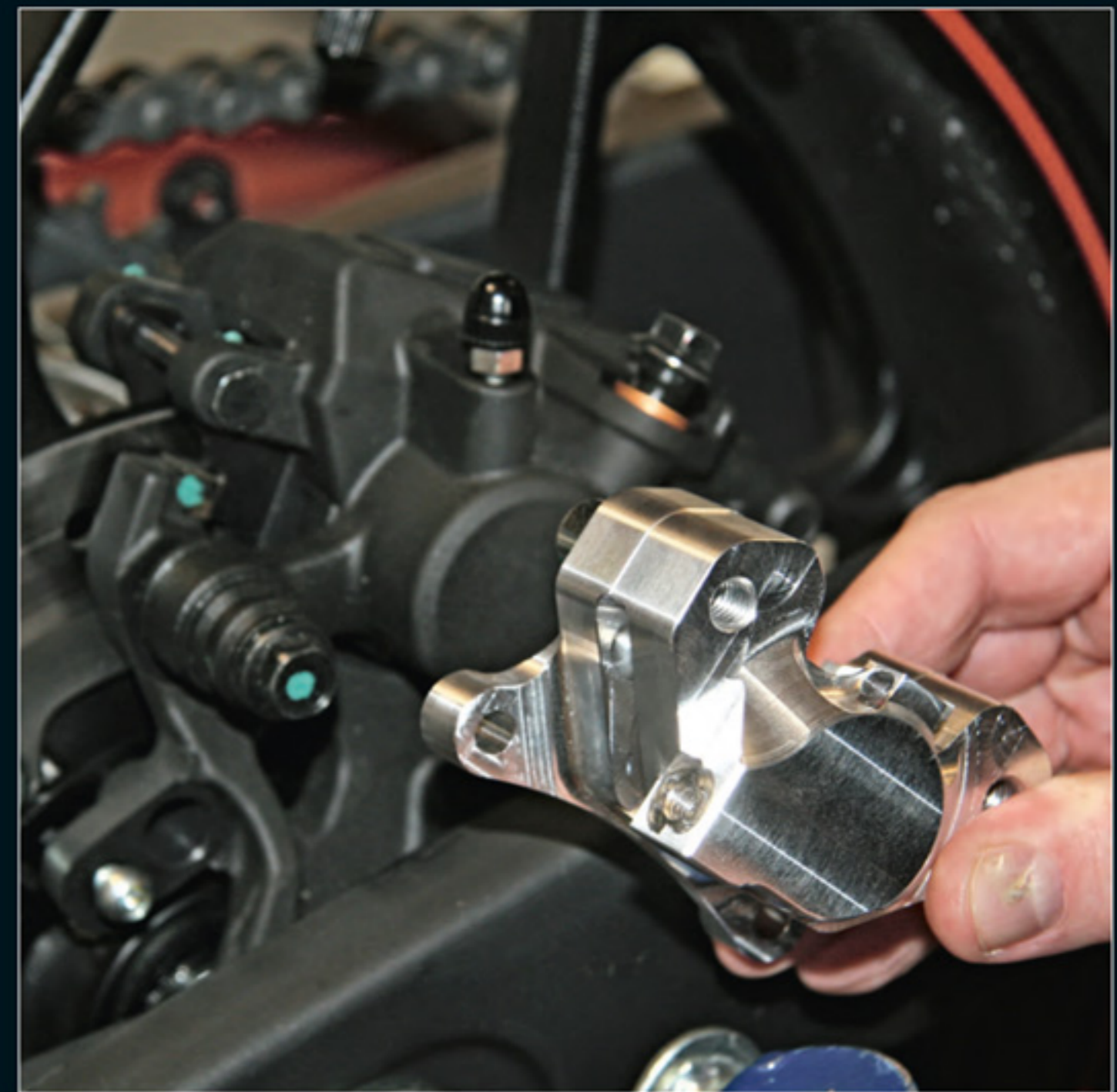
Halb so groß scheint der Prototyp eines Bremssattels für die neue 300er-Klasse
