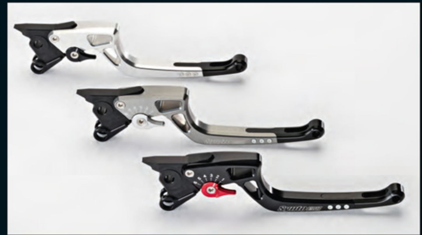
Die Syto Evo-Hebel lassen sich in der Griffweite sechsfach einstellen und für den Renn-einsatz um zwei Zentimeter kürzen
