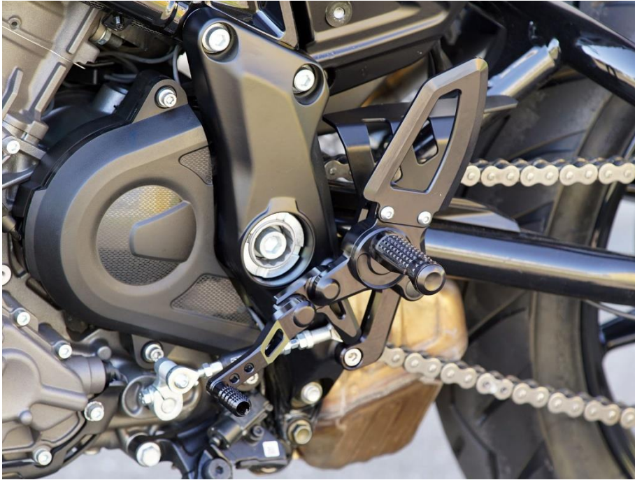
Bild 3 von 6: Drei mögliche Positionen für die Pedale (am Bsp. der Version 'Racing')
