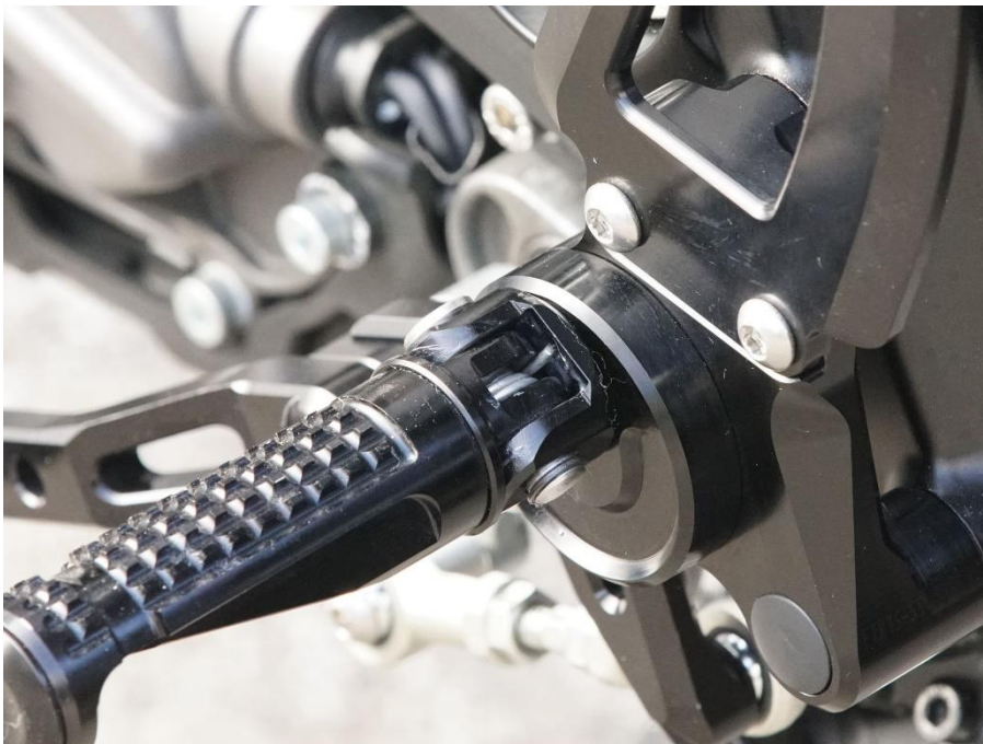
Bild 4 von 6: Verstellbereich für Rasten: Excenter mit feinsten Verzahnung
