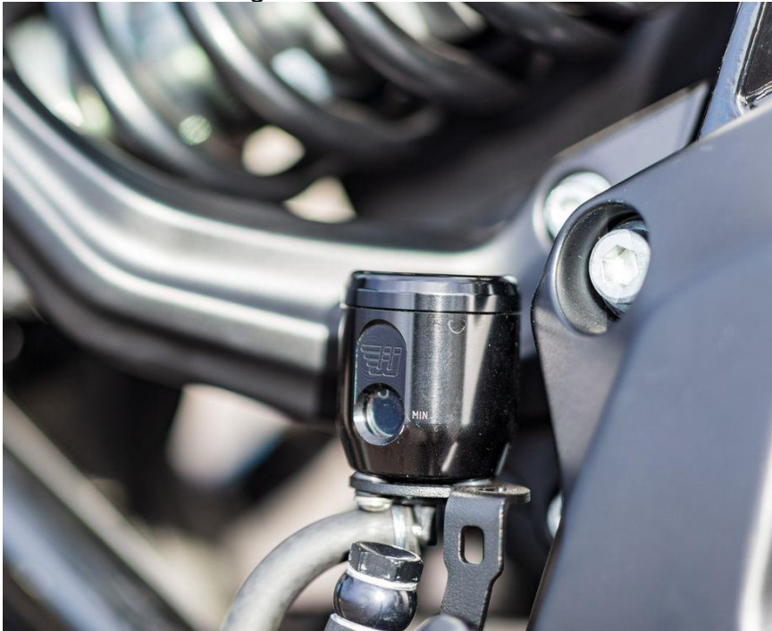
Bild 11 von 13: Ausgleichsbehälter für Fußbremse & Handbremsarmatur
