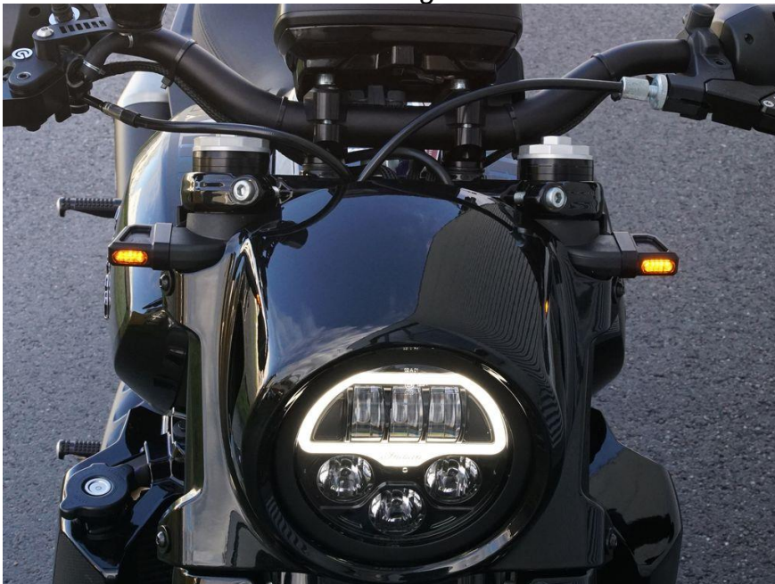
Bild 6 von 13: Auch für die Front gibt es neue LED Blinker
