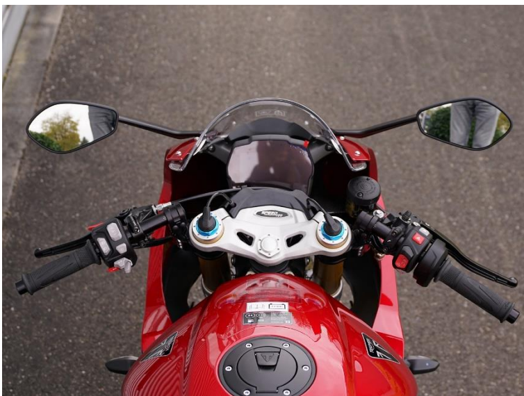
Bild 2: Lenker legt insgesamt um ca. 4 cm in der Breite zu
