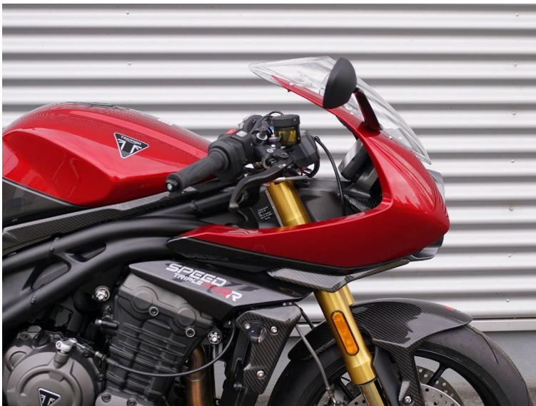
Bild 2: Lenker legt insgesamt um ca. 4 cm in der Breite zu
